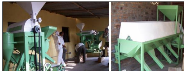
P 1.1: Installation of PKV mini dal mill PKV cleaner/grader cum polisher
