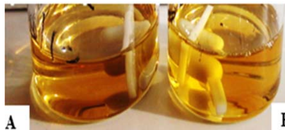
Fig 1: Images of A : \mu Emulsion T-F0 (W/O) et B : \mu Emulsion Labrasol-F0 ; (O/W)
